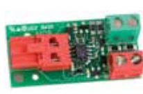
Шинный интерфейс XIB (для платы E045 или E024S с фотоэлементом без возмож- ности подключения к шине)
